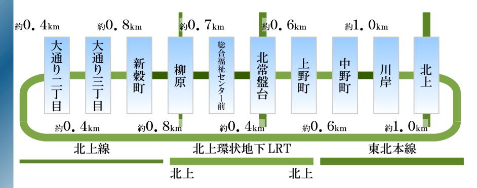
日常業務を超える検修が必要な時は技術者を呼び寄せる柳原に車両搬入・車両搬出を目的とした渡り線を設ける 全長:約6.7km・平均駅間距離:約0.7km
